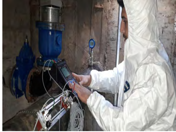
DMA içerisinde yapılan debi basınç ölçümleri
