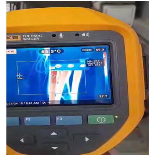
Termal Kamera ile Yapılan Ölçüm Isı Farkları
