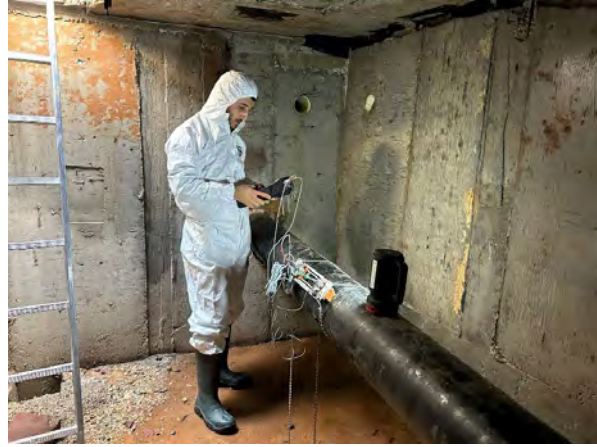
DMA içerisinde yapılan debi basınç ölçümleri
