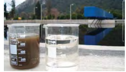
Hurma İleri Biyolojik Atıksu Arıtma Tesis Giriş Atıksu - Çıkış Arıtılmış Su Örneği
