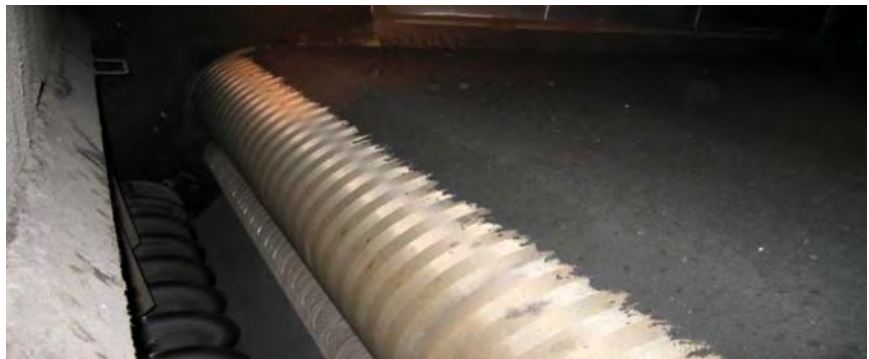
Ürüne Kaplı Kurutucu Bandının Dahili Görünümü
